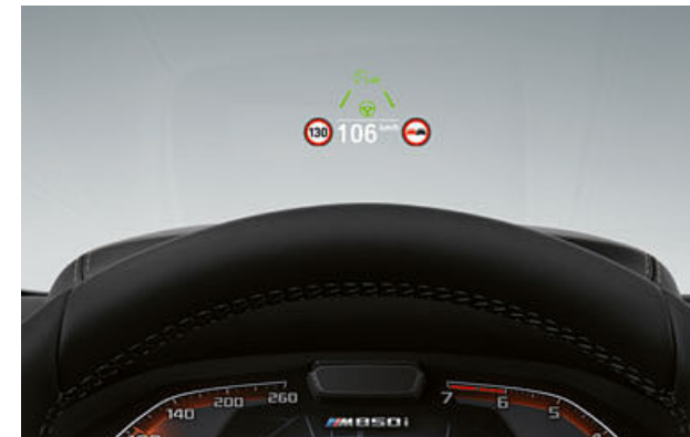
DAS BMW HEAD-UP DISPLAY PROJIZIERT FAHRRELEVANTE INFORMATIONEN ABLENKUNGSFREI INS SICHTFELD DES FAHRERS.
