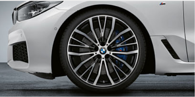
○ Die hochwertigen 21" Leichtmetallräder V-Speiche 687 sind in Bicolor Schwarz, sichtsseitig glanzgedreht und mit gewichtsoptimiertem, gewalztem Felgenbett ausgeführt. Sommer-Komplettradsatz mit Runflat-Mischbereifung, Radgröße 8,5J x 21 mit Reifengröße 245/35 R21 96Y XL RSC vorn und 10J x 21 mit Reifengröße 275/30 R21 98Y XL RSC hinten.
