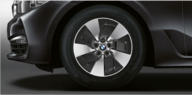
■ 17" Leichtmetallräder Turbinenstyling 645 in Bicolor Orbitgrau glanzgedreht, BMW EfficientDynamics, Radgröße 7,5J x 17, Bereifung 225/60 R17.
