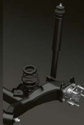
Verbundlenker-Hinterachse mit speziell designedem Längslenker
