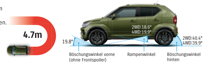
Minimum Bodenfreiheit: 180 mm (ohne Frontspoiler)
