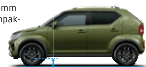
Minimum Bodenfreiheit: 180 mm (ohne Frontspoiler)
