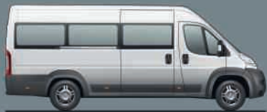
Bus 40 L4H2 – 17 places : longueur 6863 mm – largeur extérieure 2050 mm – hauteur extérieure 2524 (2850 avec climatisation additionnelle).
