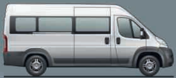
Bus 40 L3H2 – 14 places : longueur 5998 mm – largeur extérieure 2050 mm – hauteur extérieure 2524 (2850 avec climatisation additionnelle).
