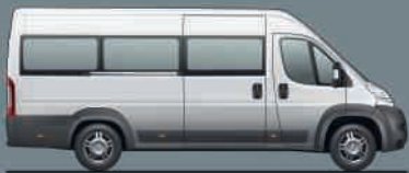
Bus 40 L4H2 – 17 Plätze: Länge 6863 mm – Aussenbreite 2050 mm – Aussenhöhe 2524 mm (2850 mm mit zusätzlicher Klimaanlage).
