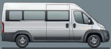
Bus 40 L3H2 – 14 Plätze: Länge 5998 mm – Aussenbreite 2050 mm – Aussenhöhe 2524 mm (2850 mm mit zusätzlicher Klimaanlage).
