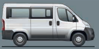
Kombi oder Loisirs 30 L1H1 – 9 Plätze: Länge 4963 mm – Aussenbreite 2050 mm – Aussenhöhe 2254 mm.
