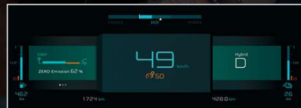
Modalità Quadranti: permette di visualizzare le informazioni legate alla modalità di guida ELECTRIC, HYBRID o SPORT.
