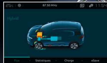
Flux d'énergie: permet de visualiser le fonctionnement de la technologie hybride.
