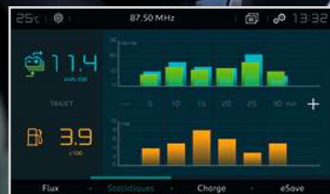
Statistiques: permet de connaître sa consommation électrique et thermique pour optimiser sa conduite.
