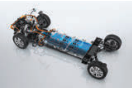
Integrierte Batterie im Fahrzeugboden. Ladevolumen (Vivaro-e) und Passagierbereich (Zafira-e Life) bleiben unverändert gegenüber der Verbrennerversion
