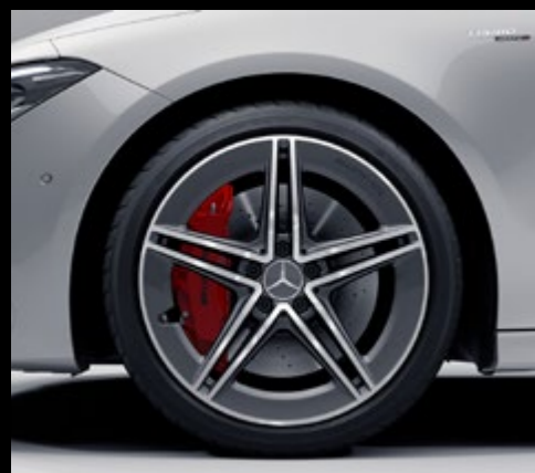
RTG – Cerchi in lega leggera AMG da 19" a 5 doppie razze Di serie Con 255/35 R 19 su 9 J×19
