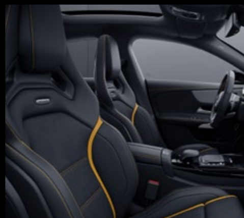
671A – Pelle ecologica ARTICO microfibra DINAMICA AMG nera e cuciture gialle – Di serie
