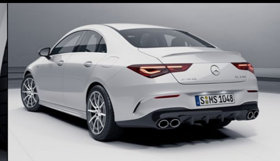
Due mascherine di uscita di scarico doppie rotonde con diametro rispettivamente di 82 mm
