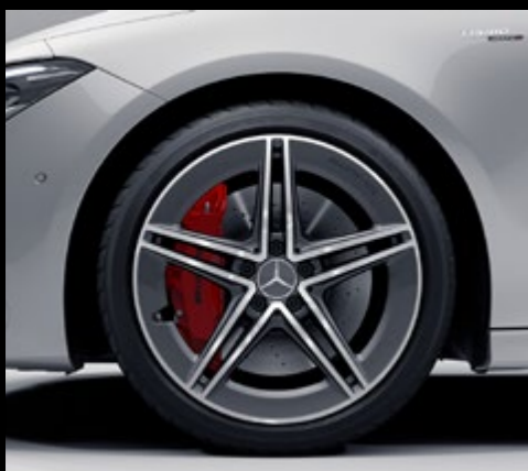
RTG - Jantes alliage AMG de 19" à 5 doubles branches Série Monte 255/35 R 19 sur 9 J × 19
