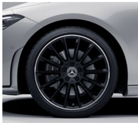
RVK - Jantes alliage AMG de 19" multibranches - Option avec Pack Sport Black (CHF 1280.-) Monte 225/40 R 19 sur 7,5 J × 19
