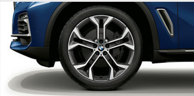
□ 21" Leichtmetallräder Y-Speiche 744 Bicolor Orbitgrau mit Mischbereifung und Notlaufeigenschaften, glanzgedreht, Radgröße vorn 9,5J x 21, Bereifung 275/40 R21, Radgröße hinten 10,5J x 21, Bereifung 315/35 R21. 1
