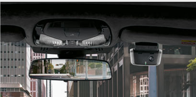
○ Das BMW Advanced Car Eye 2.0 ist eine hochempfindliche Full-HD-Kamera, die das Geschehen vor und hinter dem Fahrzeug auch im geparkten Zustand im Blick hat. Bei Erschütterungen und außergewöhnlichen Bewegungen außerhalb des Fahrzeugs speichert die Kamera automatisch die Situation, um mögliche Unfälle oder auch (versuchte) Einbrüche zu dokumentieren.
