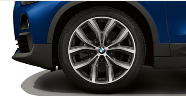
□ 19" Leichtmetallräder Y-Speiche 511, Orbitgrau, glanzgedreht, mit Notlaufeigenschaften, Radgröße 8J x 19, Bereifung 225/45 R19.
