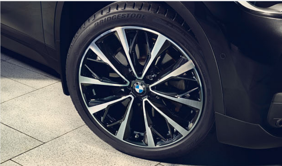
○ Die hochwertigen 19" Leichtmetallräder V-Speiche 573 sind in Bicolor Schwarz, sichtsseitig glanzgedreht und gewichtsoptimiert ausgeführt. Sommer-Komplettradsatz mit Runflat-Bereifung, Radgröße 8J x 19 mit Reifengröße 225/45 R19 92W RSC.
