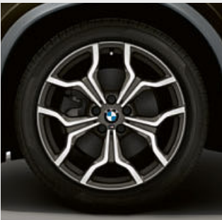
■ 19" M Leichtmetallräder Y-Speiche 2 722 M, Orbitgray, glanzgedreht, mit Notlauf-eigenschaften, Radgröße 8J x 19, Bereifung 225/45 R19.
