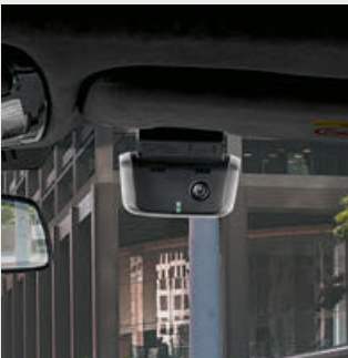
○ Die hochempfindliche Full-HD-Kamera zeichnet bei Erschütterungen automatisch das Geschehen vor und hinter dem Fahrzeug auf.
