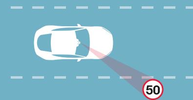
**Die Verkehrszeichenerkennung** erkennt Tempolimits und Überholverbote und zeigt sie im leicht ablesbaren Kombiinstrument an, damit Sie vollständig informiert sind und sich ganz auf den Verkehr konzentrieren können.
