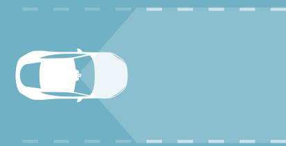
**Der Spurhalteassistent** registriert ein unbeabsichtigtes Verlassen der Fahrspur und unterstützt Sie durch sanfte Lenkimpulse dabei, das Fahrzeug zurückzulenken.
