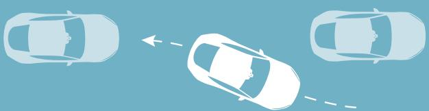
**Der Parkassistent** (optional) kann das Parken erleichtern, indem er selbstständig die erforderlichen Lenkbewegungen vornimmt, um Ihr Fahrzeug sicher ein- und auszuparken. Legen Sie einfach die Fahrstellung oder den Rückwärtsgang ein, und steuern Sie die Geschwindigkeit des Fahrzeugs mithilfe von Brems- und Gaspedal. Anzeigen und Hinweise helfen dem Fahrer beim Parkvorgang.
