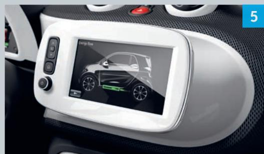
5 **I dettagli sul consumo relativa al flusso di energia** permettono di visualizzare minuto per minuto quanta energia viene consumata o recuperata.
