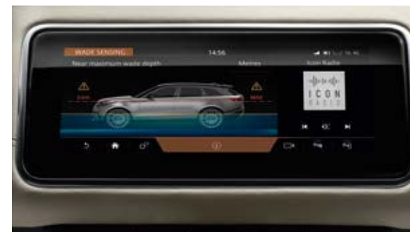
Wade Sensing (détection de passage à gué)
