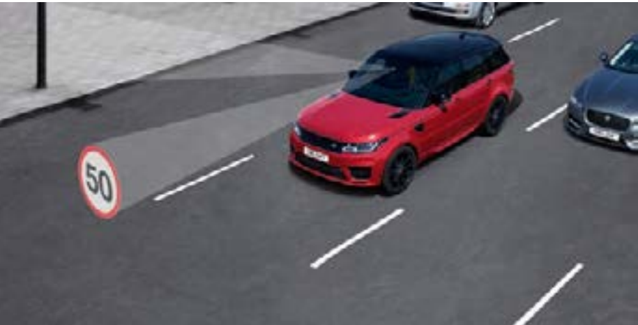
Reconnaissance de la signalisation routière avec limiteur de vitesse adaptatif
